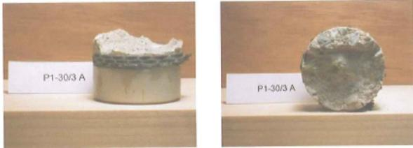
Figura 30 – Provino P1-30/3 A: Superficie di rottura
