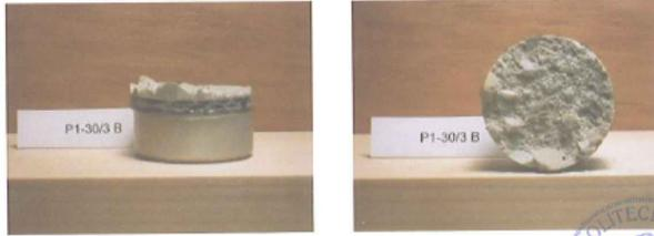
Figura 31 – Provino P1-30/3 B: Superficie di rottura
