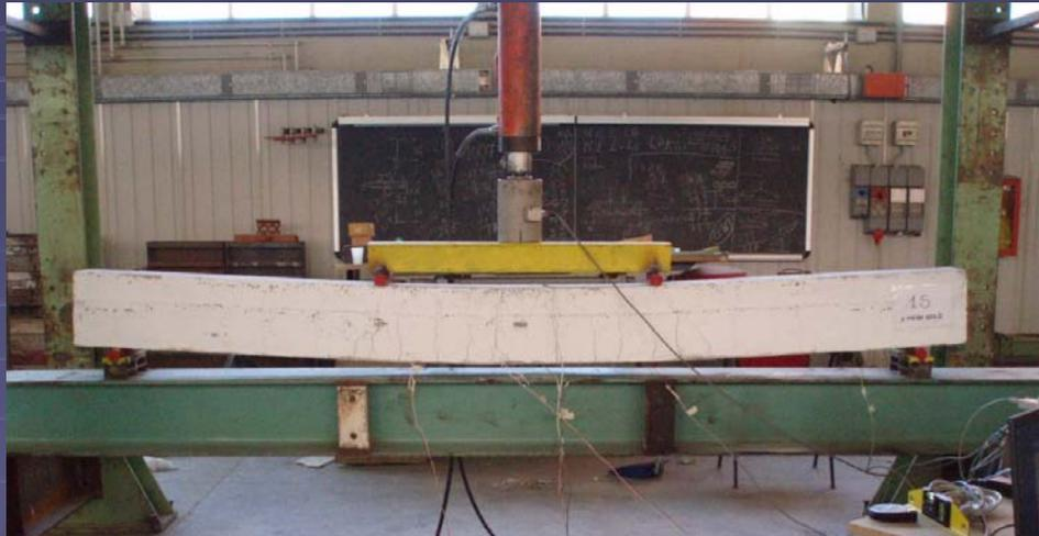
Trave S2-T1-P1 rottura di tipo flessionale (cedimento del calcestruzzo compresso)
