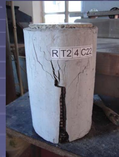
La rottura dei provini è avvenuta in modo graduale a seguito della formazione di ampie fessure verticali. Al collasso il calcestruzzo all'interno del rinforzo si è completamente disgregato
