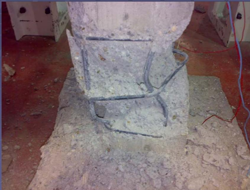
Rottura del provino non confinato: schiacciamento del calcestruzzo e della successiva instabilizzazione delle barre longitudinali nel tratto compreso tra due staffe. La rottura è avvenuta in prossimità della sezione di base ed è stata caratterizzata dalla formazione di un'ampia ed estesa lesione inclinata a circa  $45^\circ$  lungo l'altezza del provino
