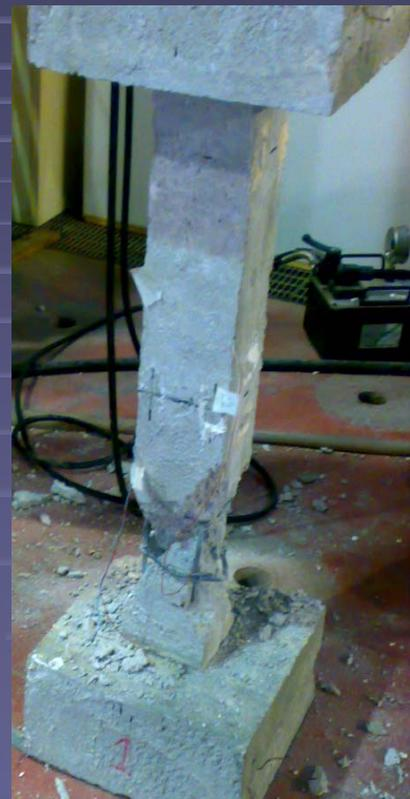
La misura della deformazione sulle facce del provino ha evidenziato la presenza di una pressoflessione con piccola eccentricità
