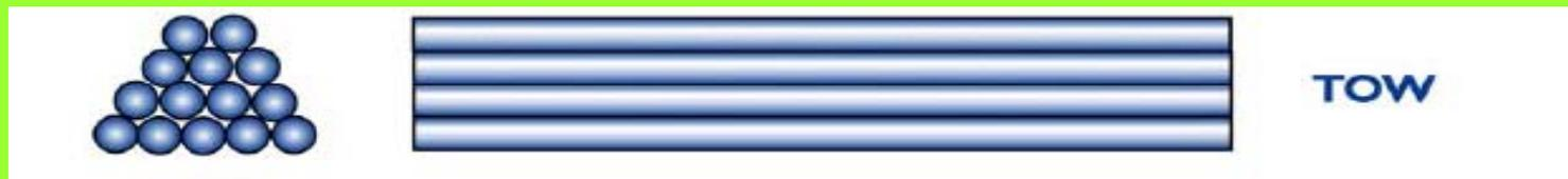
Hilado o Cable de filamentos (**tow**): producido por la máquina de hilado
