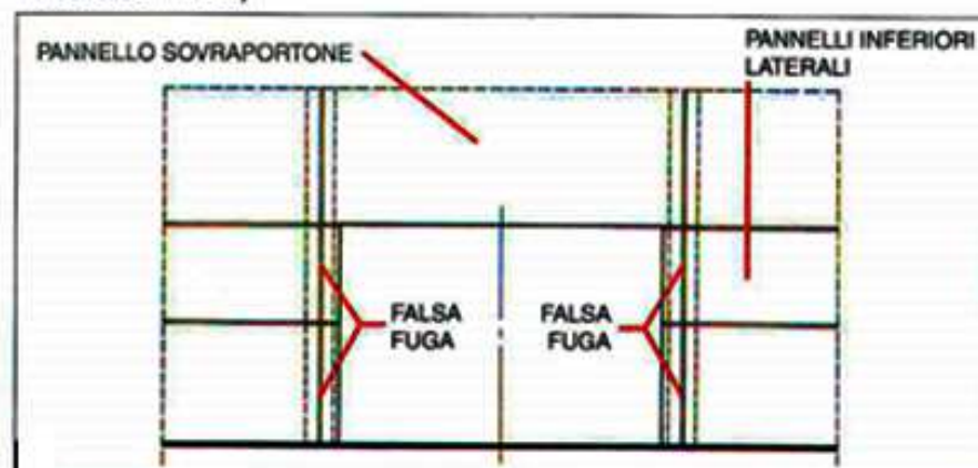
Pannelli orizzontali: pannello sovrapportone appoggiato al prolungamento dei pannelli inferiori laterali
