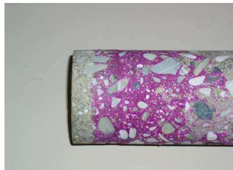
Esempio di carota trattata con fenolftaleina per la determinazione della profondità di carbonatazione
