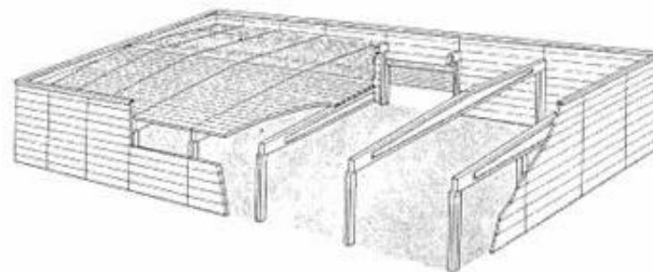
Struttura monopiano con portali indipendenti supportanti copertura e facciata perimetrale
