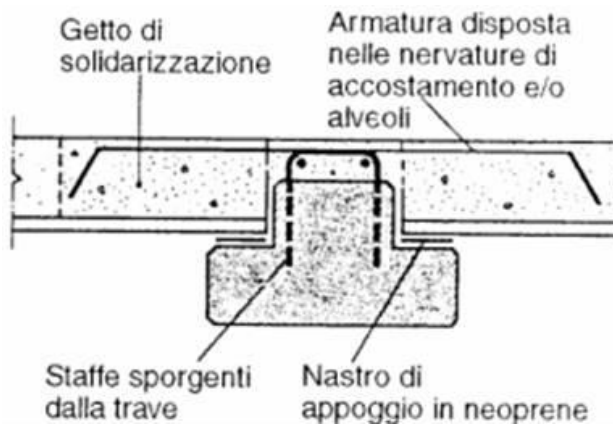
Esempio di collegamento trave – solaio di piano
